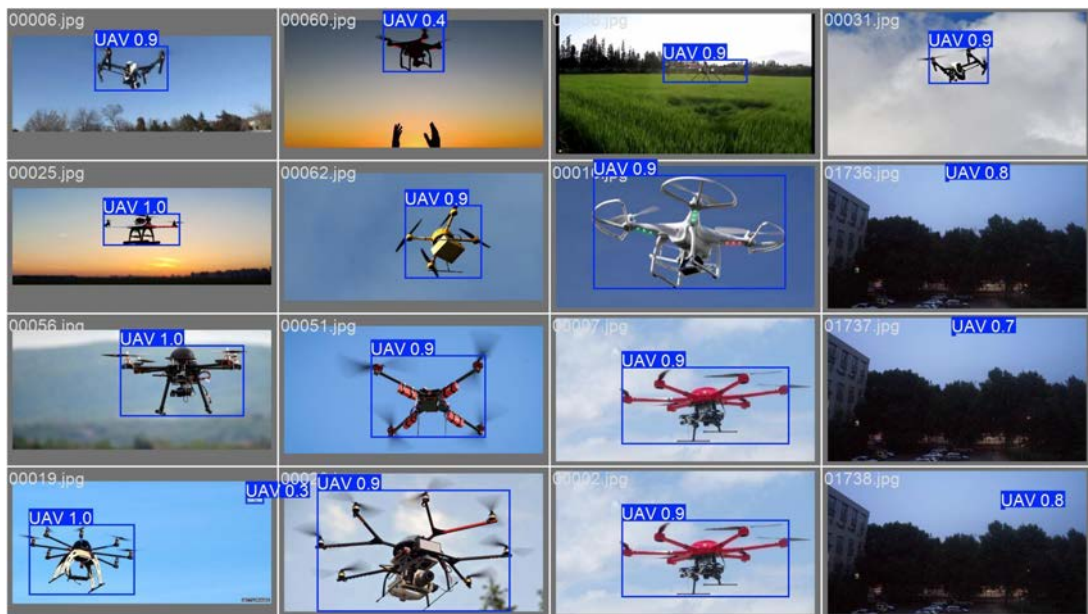
Рис. 5. Приклад розпізнавання БПЛА на валідаційному наборі даних для моделі YOLOv10s
